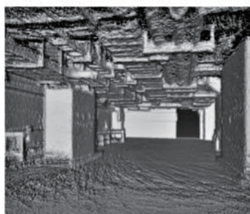
レーザースキャナによる地下空間の地形取得
