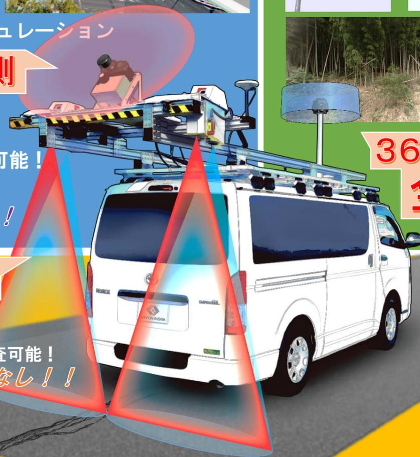
LCMSは進行方向に3mm間隔に取得した断面形状と輝度情報を結合したデータを生成し、解析を自動で行い、判定結果の数値情報を『属性』として保持します。
